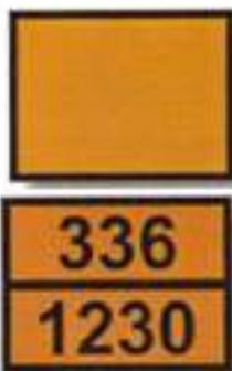
Plaques orange réfléchissantes (dimension de 40 cm par 30 cm), placées à l'avant et à l'arrière, ou sur les côtés du moyen de transport.
